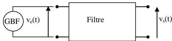
Figure 1 : Schéma de principe d'un filtre en électronique
